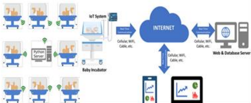
Gambar 9. Inkubator bayi cerdas yang mengerti tangisan bayi [Fahmi et al.,2020]
